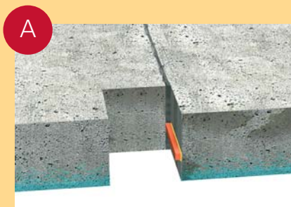
Узел А. Прокладка набухающего шнура Masterflex® 610 и пасты Masterflex® 612W при бетонировании плиты
