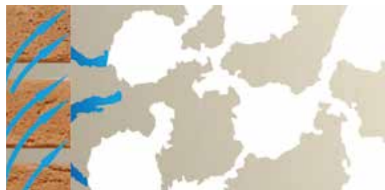
Влага из стены мигрирует в штукатурку и заполняет поры
