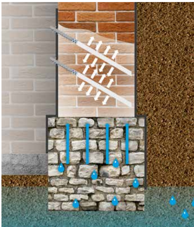
Отсечная гидроизоляция бутового фундамента
