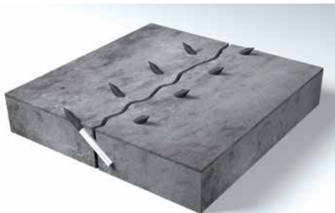
Конструкционное усиление бетонных элементов. Инъектирование сухих и влажных трещин.
