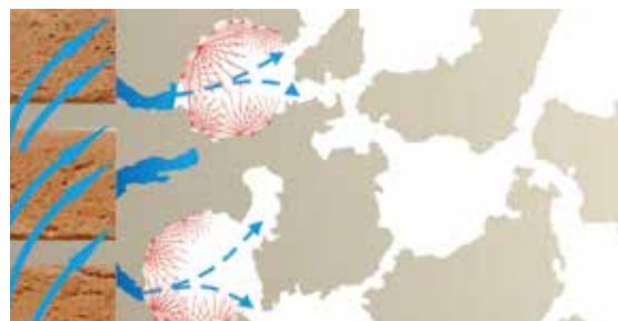
При испарении соли кристаллизуются в порах штукатурки
