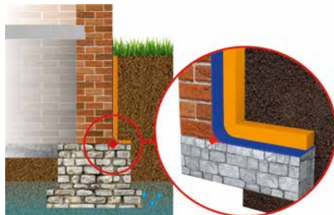
Устройство галтели с нанесением эластичной обмазочной гидроизоляции РЕНОВИР Эластик
