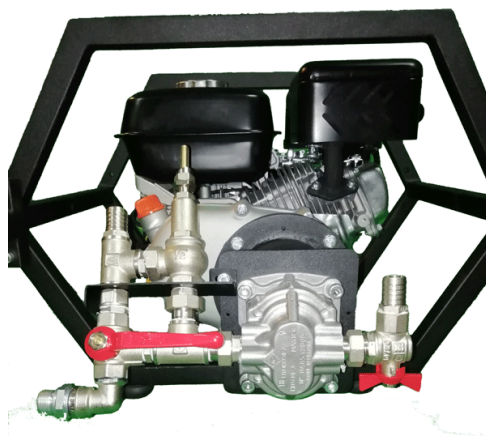
Рис. Положение входного вентиля и вентиля обратки при нанесении эмульсии
