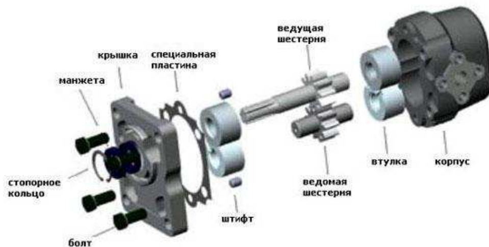
Рис. Детали шестеренного насоса
