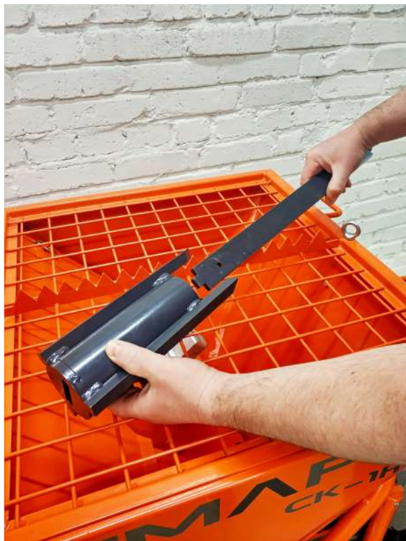
4. Соединить вал очистителя с очистителем ("рубанок"). Данные принадлежности входят в комплект станции.
