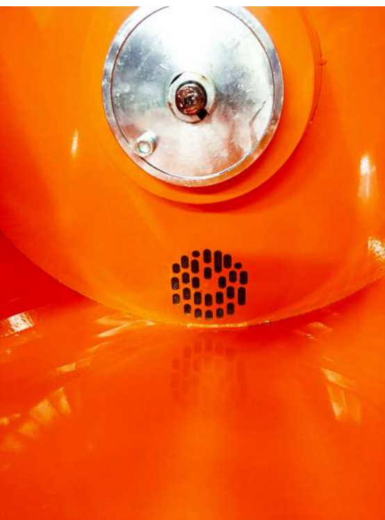
Отверстие для чистки загрузочного бункера. Вид сверху.
