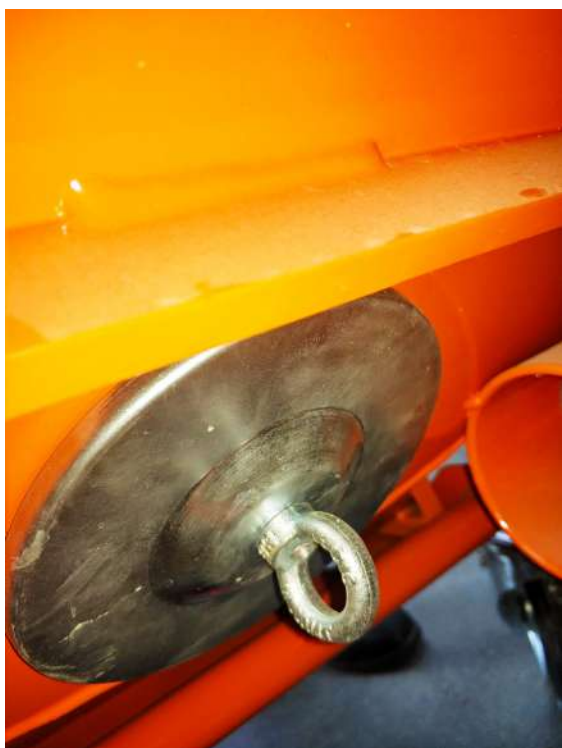
Отверстие для чистки загрузочного бункера. Вид снизу.
