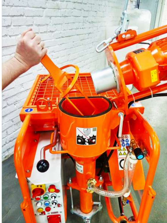
3. Извлечь смешательную спираль и очистить ее. Очистить верхнюю часть смешательной камеры.
