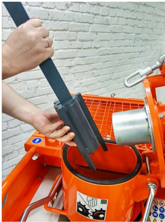
5. Вставить вал с очистителем в специальную прорезь на роторе шнековой пары.
