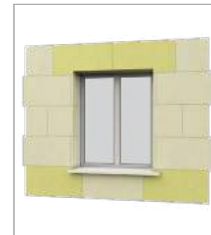
Правильное расположение панелей по периметру проемов
