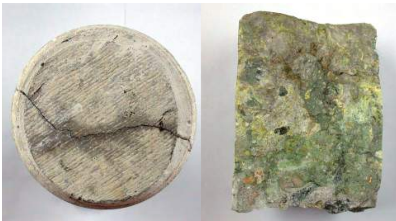
Рис. 12. Образец, взятый из сердцевины бетона, разрушенной структуры
