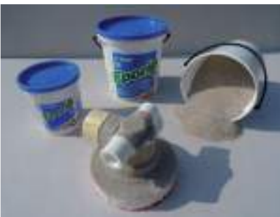
Рисунок 3.4 – Нанесение слоя EPORIP на компоненты циркулирующей установки
