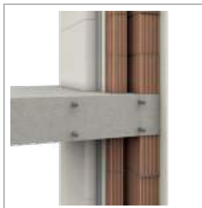
Стратиграфическое представление конструкции с внутренней теплоизоляцией
