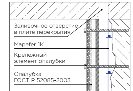
Укладка ремонтного состава
